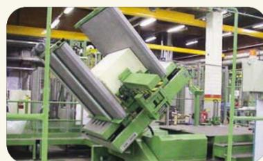
**PT2500APA** - Automatico caricamento laterale per fogli di formato massimo 1450 x 1600mm. installato in una linea di imballaggio di una cartiera
