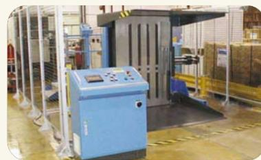
**PT1800APA** - Voltapila automatico con formato massimo 1200 x 1600 mm. installato in un'azienda cartotecnica.
