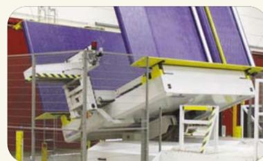
**PT3500APA** - Automatico, caricamento laterale per fogli di formato massimo 1600 x 3300mm. Installato in un'azienda di imballaggio per arieggiare, vibrare e allineare il cartone.
