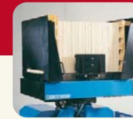
La pila viene allineata in entrambi i lati. Il sistema di aerazione separa i fogli uno ad uno.
