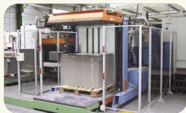
**PT2500APA** - Automatico con caricamento frontale per fogli di dimensione massima 1200 x 1450mm. installato in un'azienda per la produzione di imballaggi
