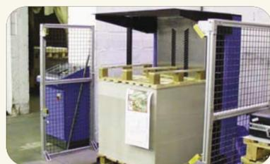
**PT1000APA** - Voltapila automatico con formato massimo 740 x 1040mm. installato in una tipografia.
