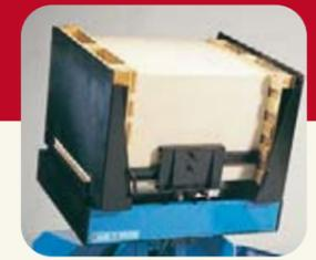
Durante l'aerazione e la vibrazione, la pila viene centrata sul bancale dalla guida regolabile. Durante questa operazione l'operatore può togliere eventuali fogli difettosi con estrema facilità.
