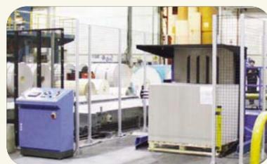
**PT1500APA** - Voltapila automatico con formato massimo 1040 x 1440mm. installato in un'azienda per la lavorazione della carta.
